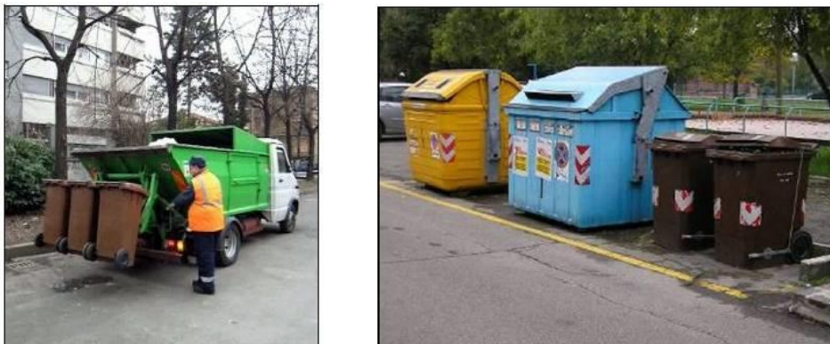
Εικόνα 3: Σύστημα συλλογής σε κεντρικούς κάδους ανά ομάδα κατοικιών και διαδικασία αποκομιδής
